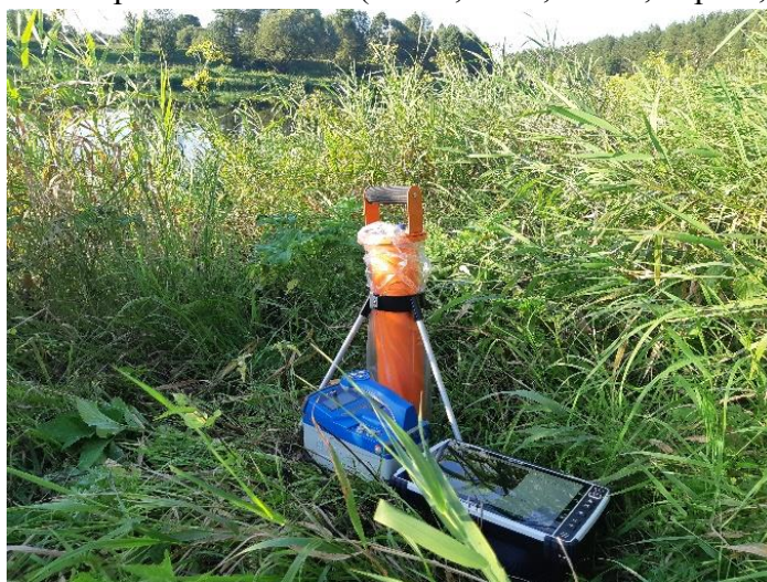
Рисунок 6 – Выполнение параллельных измерений двумя различными приборами на береговой линии реки Вилия МКС-АТ6101ДР, МКС-АТ6102А.
