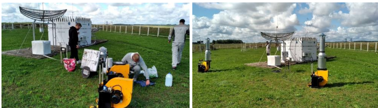
Рисунок 7 – Сбор и установка ВФУ-1200 и стенда контроля углерода и трития на метеорологической станции Маркуны.
